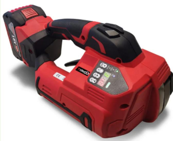
**La reggiatrice a batteria Typhoon è particolarmente indicata per il settore industriale e poli logistici. Effettua il tensionamento, saldatura e taglio della reggia tramite pulsante multifunzione. Utilizza reggia in PP/PET da 13 e 16 mm. E' possibile lavorare nella modalità automatica, semiautomatica e manuale. Il prodotto viene fornito con batteria Bosch Professional da 18V e caricabatterie a ricarica rapida.**
