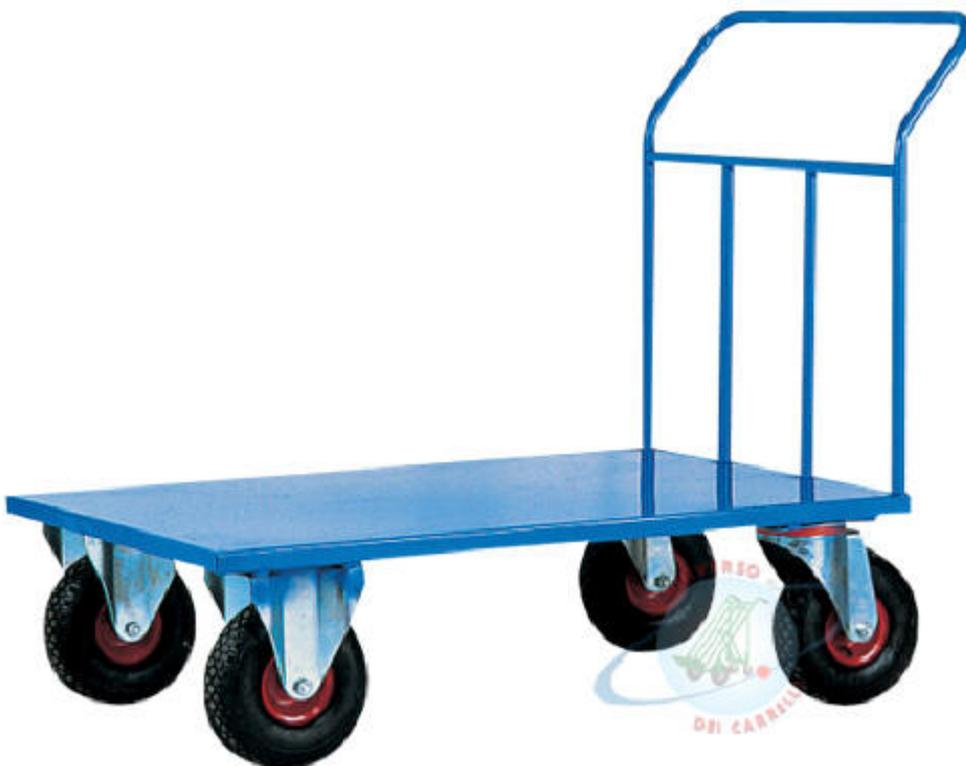
Pianale in lamiera con chassy portante in tubolare. Piano di appoggio in lamiera 20/10 con telaio portante in tubolari. Le contropiastre saldate alla struttura permettono una rapida sostituzione del supporto ruota.
